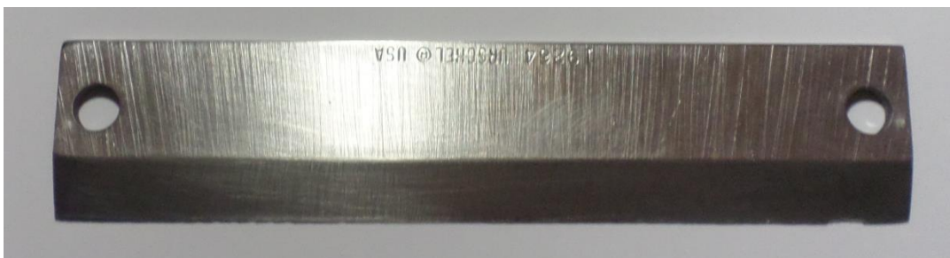
FIGURA 4 - Lâmina de aço inoxidável martensítico AISI 420
